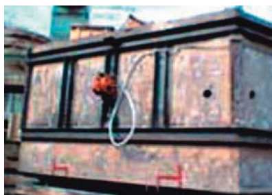
Verdichten von Formsand
