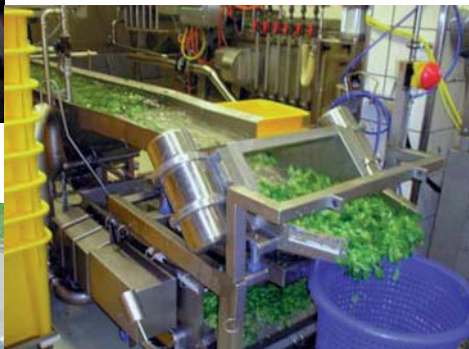
Fördersiebrinne, angetrieben mit Edelstahl-Elektro-Außenvibratoren
