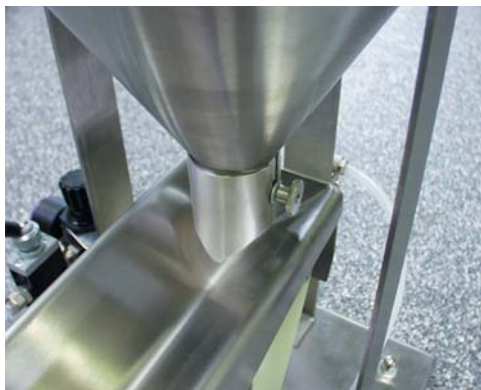
Dosierstutzen am Behälteraustausch
