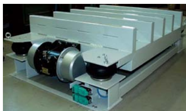
VTF/R 10/12 mit 2 NEG 251370 E für ATEX konforme Anwendung
