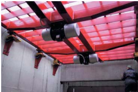
Sieben von grobem Schüttgut mit Elektro-Außenvibratoren
