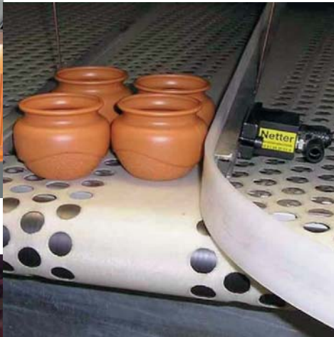
Vermeiden von Produktstaus mit Druckluft-Kreisschwingern
