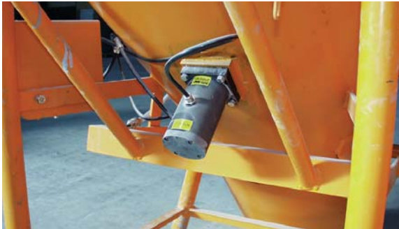
Austragshilfe am Behälter
