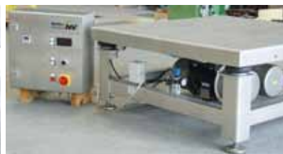
SRF und Vibrationstisch in Edelstahl
