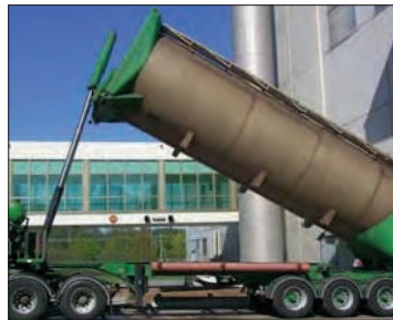
Entleeren von Silofahrzeugen
