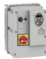
NFI-Geräte sind Frequenzumrichter mit Motorabgang im IP 54-Gehäuse für Wandmontage, bestückt mit Hauptschalter, Drehrichtungswahlschalter und Sollwertpotentiometer.
