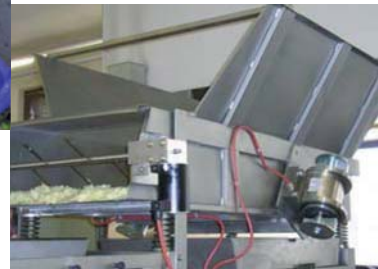
Fördern mit Edelstahl-Elektro- Außenvibratoren
