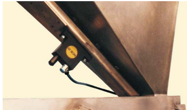
Entleeren ohne Brückenbildung
