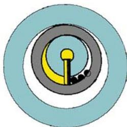
In dieser Position kann der Vibrator einwandfrei anlaufen, die Lamelle ist frei. Die Abluftbohrungen sind unten rechts.
